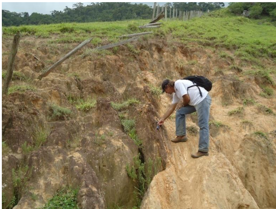
Figura 9- Provável zona de cisalhamento composta por gnaiss alterado (coloração amarela esbranquiçada).
